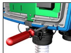
Figure 29 – Groupe d'extraction « HEALTHBOX » (accès au ventilateur)
